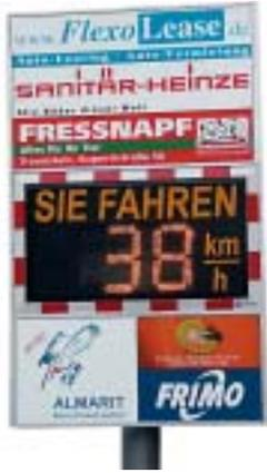
Die Stadt Freilassing hat ein über Werbung finanziertes Geschwindigkeitsmessgerät erhalten, das nicht fest an einem Standort installiert ist, sondern versetzt werden kann. Der Standort soll alle zwei bis drei Wochen gewechselt werden. Das Gerät zeigt den Fahrzeugkern die gefahrene Geschwindigkeit an und zeichnet die Anzahl der Fahrzeuge sowie deren Geschwindigkeiten auf.
