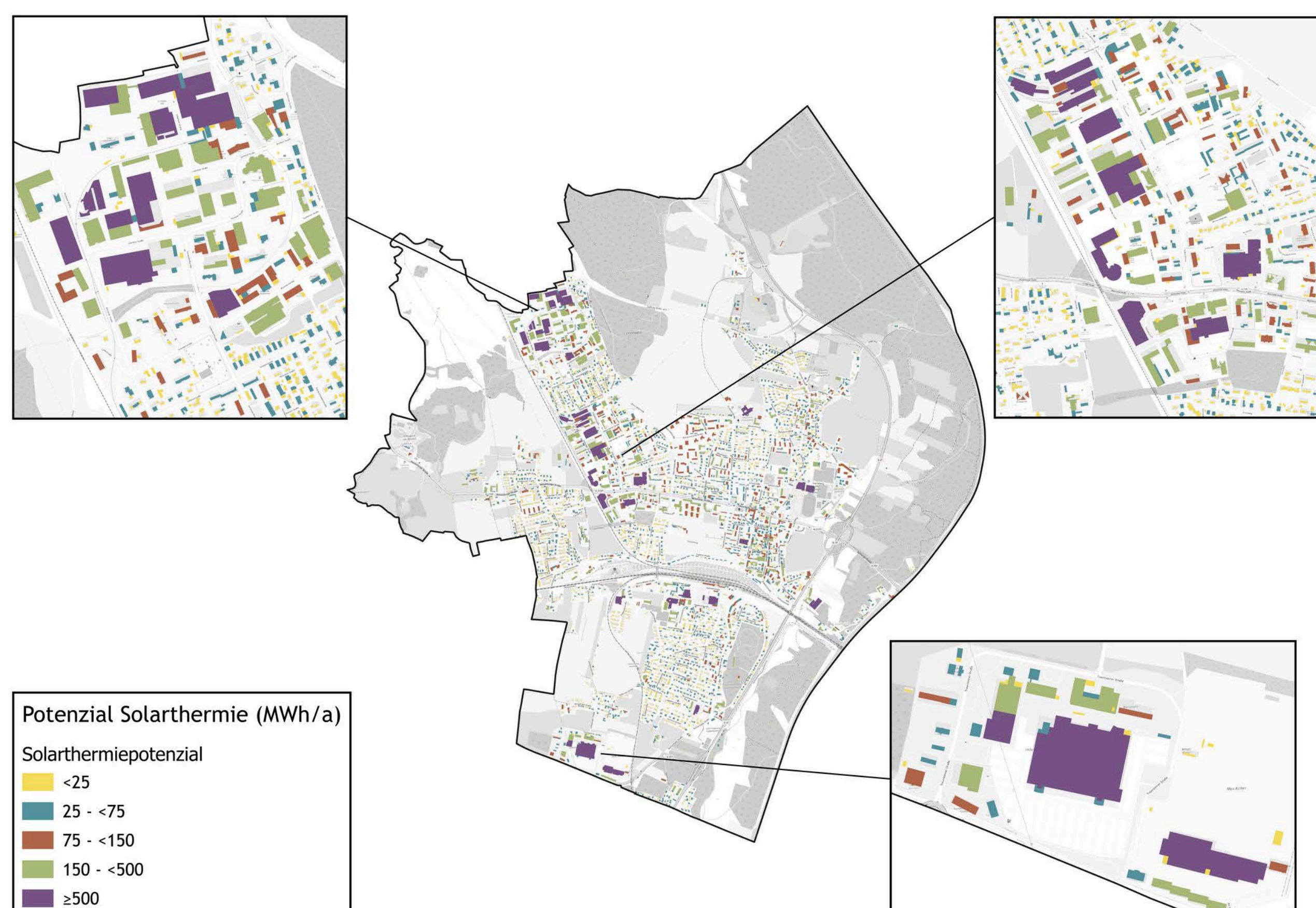
Beschreibung: Ertragspotential für Solarthermie auf Dachflächen in Freilassing Hintergrundkarte: OpenStreetMap.org
