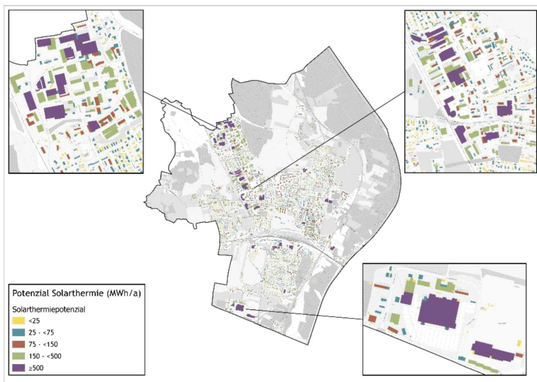
Abbildung 1: Solarthermie auf Dachflächen
